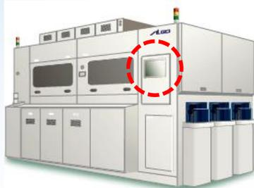
WindowsとINtimeのOSを融合させ、HMIのAI-HMIと制御のAI-PLC、AI-MotionをバンドルしたAI3ソリューションパッケージと、超高速フィールドネットワークのEtherCATにより、半導体製造装置の最適制御を実現することができます。
