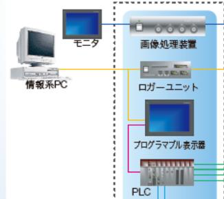
このように、従来のPLCやプログラマブル表示器、画像処理装置、ロガー装置などからなるシステムをオールインワンコントローラ1台で置換できます。
